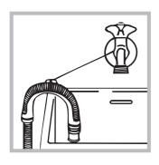
o apóyelo en el borde de un lavamanos o de una bañera, uniendo la guía suministrada con el aparato, al grifo (ver la figura). El extremo libre del tubo de desagüe no debe permanecer sumergido en el agua.
